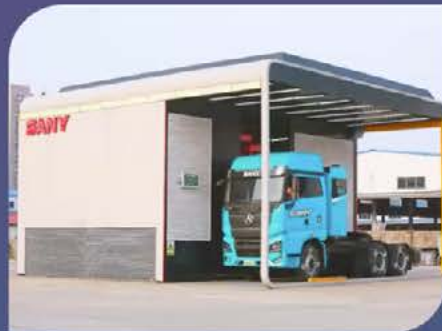
三一RGV换电站 Sany RGV sample battery swap station
